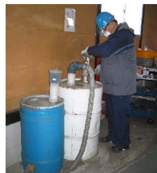
スプレー缶のガス処理
