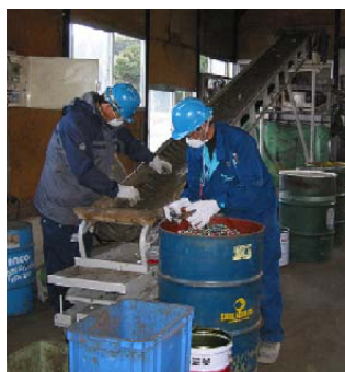
乾電池の破碎作業
